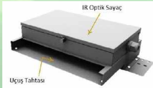
Şekil 6. Giriş-Çıkış sayımı için optik algılayıcı (Jiang vd., 2016)
