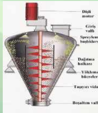
Şekil 7. Vakumlu Yağ Kaplama Makinesinin Genel Görünümü.
