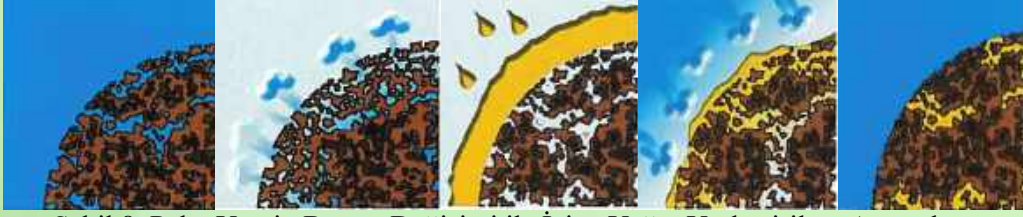
Şekil 8. Pelet Yemin Basınç Değişimi ile İçine Yağın Yerleştirilme Aşamaları.
